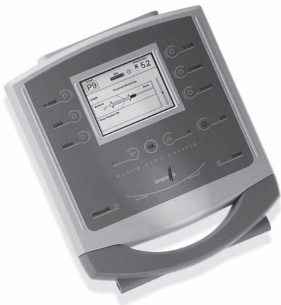
Obrázok 4 Systém Impella LP 2,5, externá jednotka (konzola), ktorá zabezpečuje pohon a preplach systému
